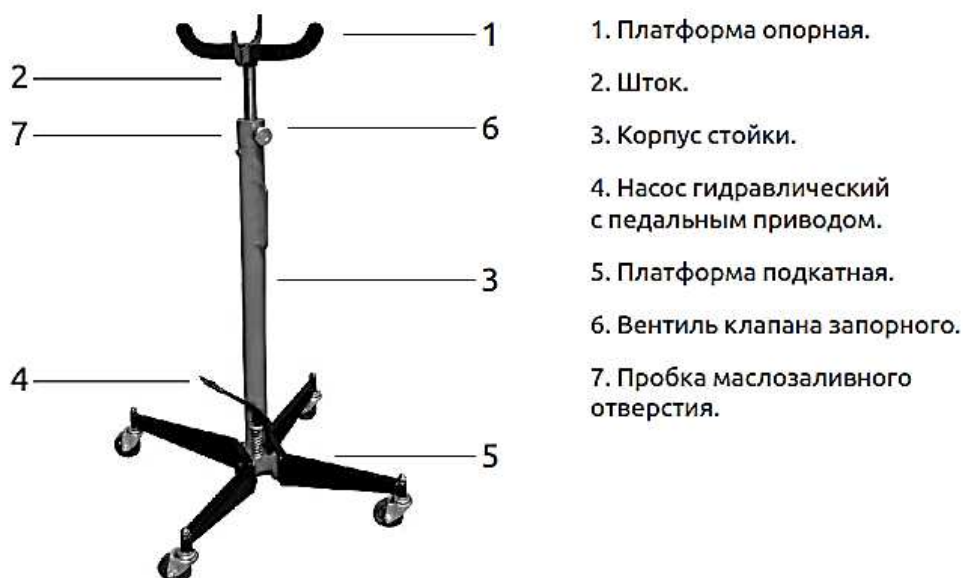
Устройство трансмиссионной стойки
